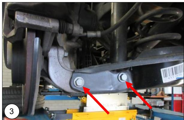
**NL** Ondersteun de draagarm en verwijder de bouten van de schokdemper en de draagarm aan de wielzijde. **Let op!** De draagarm staat onder veerspanning.
