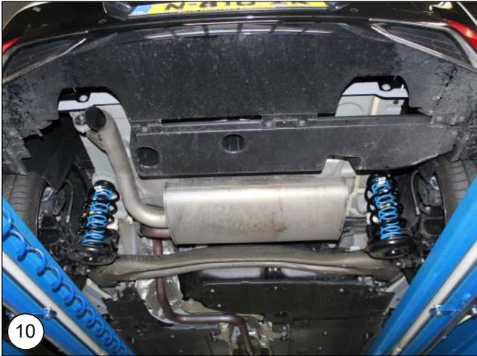
**NL** Laat het voertuig zakken op de wielen en draai de schokdemper bout vast naar het voorgeschreven aanhaalmoment. Monteer vervolgens de hoogte sensor
