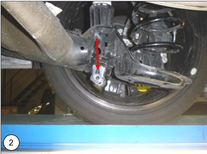
**NL** Verwijder de schokdemper bout en hef het voertuig. Let op de remslangen en kabels! Verwijder de hoogtesensor indien aanwezig.
