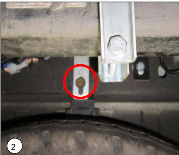
**NL** Monteer de sensorsteun aan de chassisbalk boven de magneet. Gebruik hiervoor de bestaande bout van het reservewiel frame.
