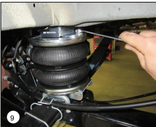
**NL** Bevestig de balg aan de bovenplaat met de M8 veerringen en M8 bouten
