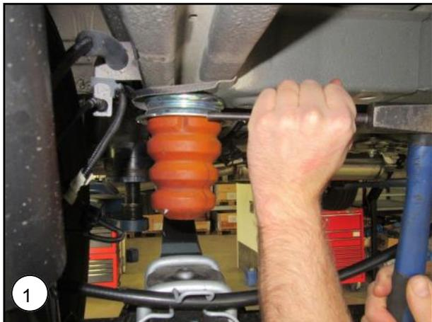
**NL** Verwijder beide aanslagrubbers van het chassis.
