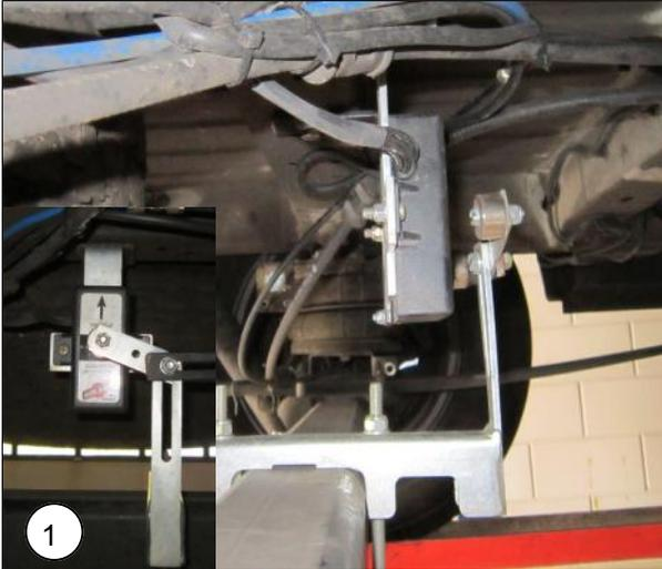
**NL** Monteer de magneetsteun op de achteras. Plaats de steun in het midden van het voertuig, zodat de magneet uitgelijnd kan worden met de sensor.
