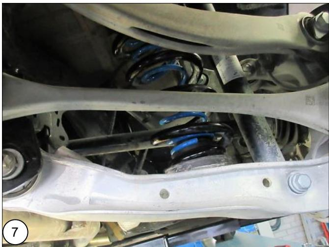
**NL** Monteer de veer terug onder de auto, ondersteun de draagarm en monteer de monter de schokdemperbout en draagarmbout. **Let op: draai deze nog niet vast!**
